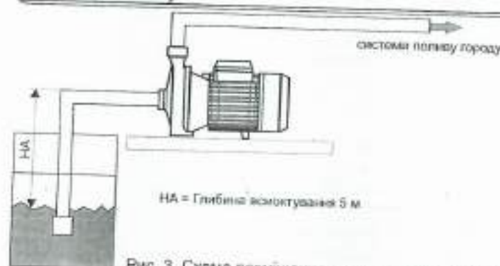
Рис. 3. Схема розміщення електронасосу "над напором"
