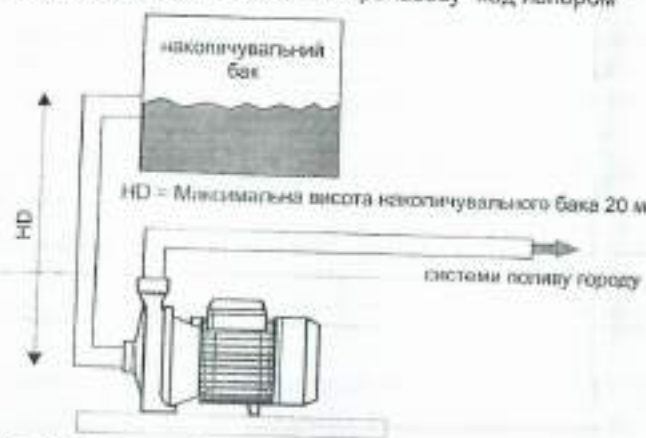
Рис. 4. Схема розміщення насоса "під напором"
