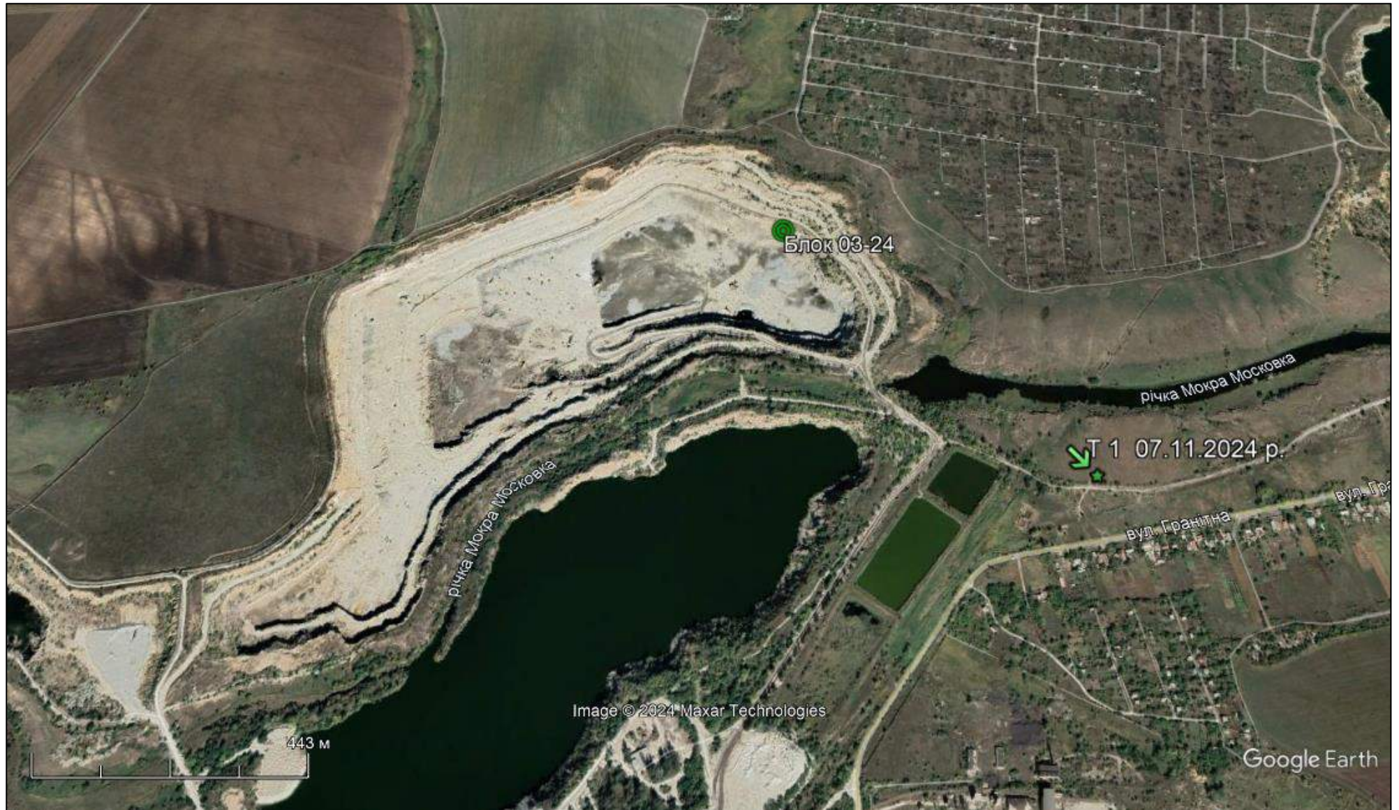
Рис.1 Точка (Т1) встановлення цифрового сейсмографа з мікрофоном та трьохосьовими геофонами для моніторингу вібрації (швидкості сейсмічних коливань ґрунту і надлишкового тиску на фронті ударної повітряної хвилі).
