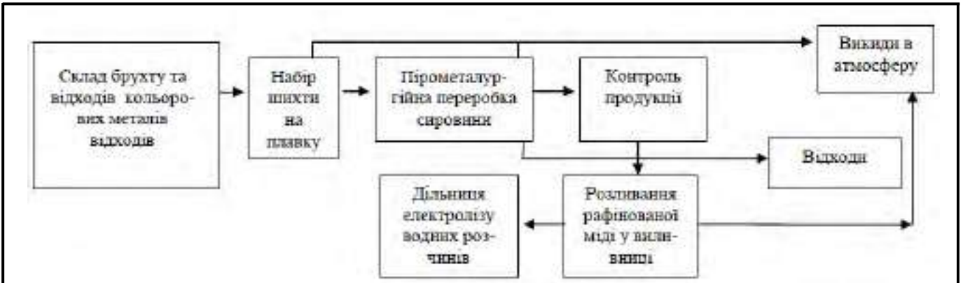
Рис. 5 - Принципова схема виробничого процесу виплавки міді
