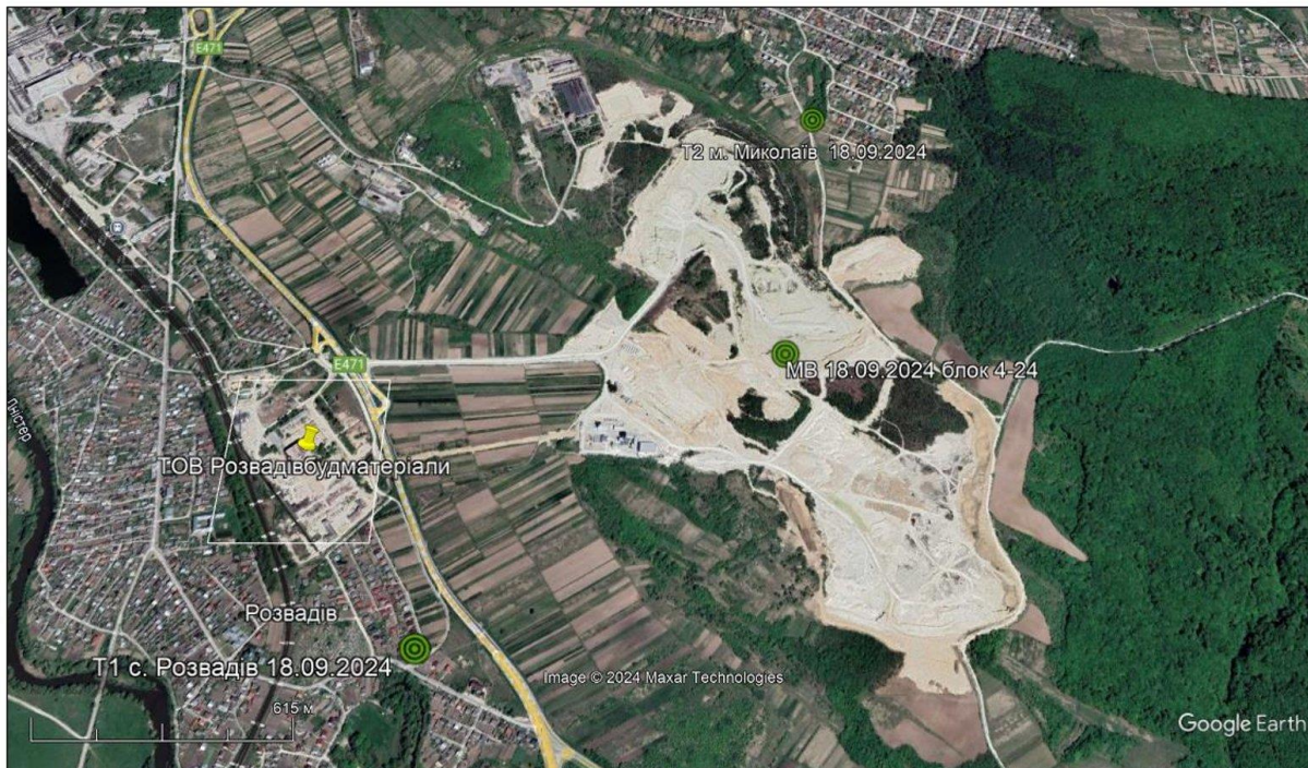
Рис.1 Точка (Т1) встановлення сейсмографа Vibracord FX та Vibracord Tellus, з мікрофоном і трьохосьовим геофоном. Точка (Т2) встановлення сейсмографа Micromate з мікрофонами та трьохосьовими геофонами і сейсмостанції ZET 048-E з трьохкомпонентним акселерометром BC 1313 при моніторингу вібрації (швидкості сейсмічних коливань ґрунту і надлишкового тиску на фронті ударної повітряної хвилі)
