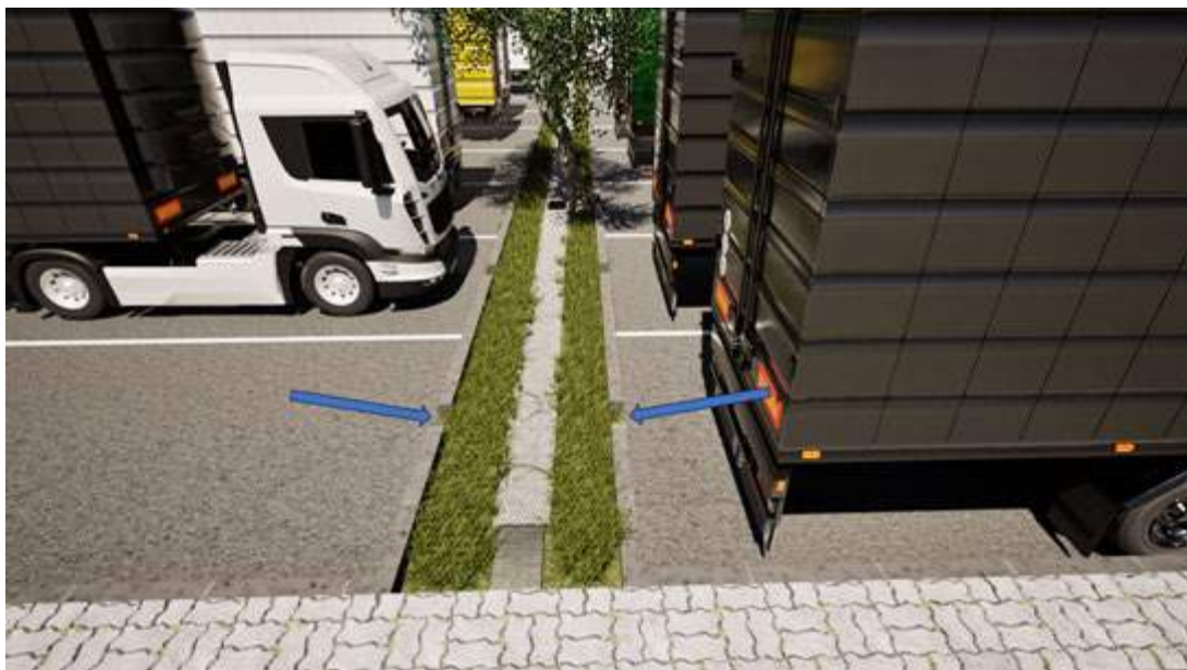
Рис. 11. 3. Візуалізація відкритої водовідвідної системи
